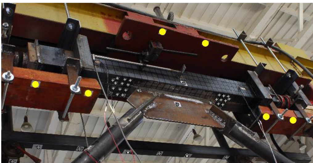
Obrázok 7.: Body ocelového rámu vykazujúce posun 10-12mm v smere osi Y.
