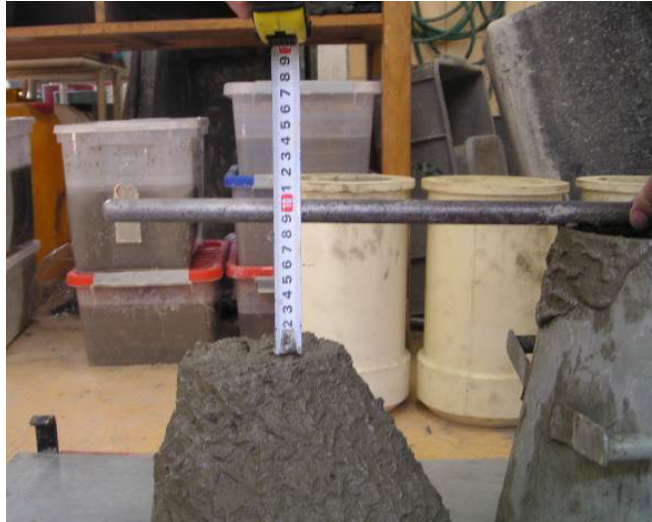
Obrázek 1.: Stanovení sednutí kužele čerstvého betonu.
