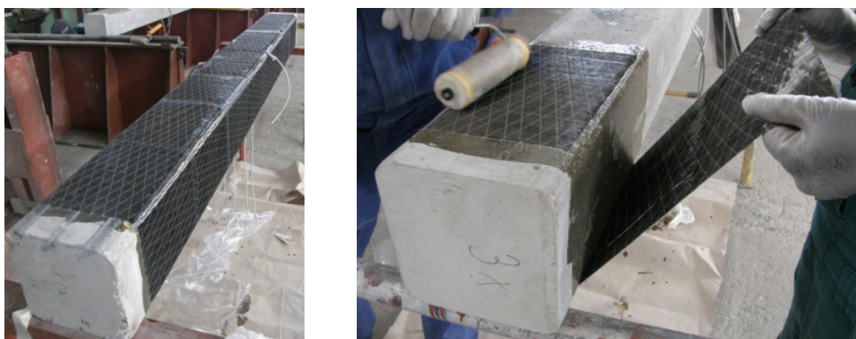
Obrázok 2.: Zosilňovanie vzoriek CFRP lamelami a tkaninou
