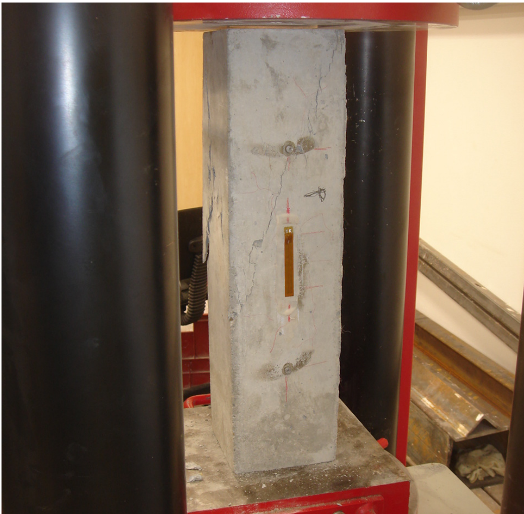
Obrázok 3.: Skúšobná vzorka MII-28-28 po porušení.
