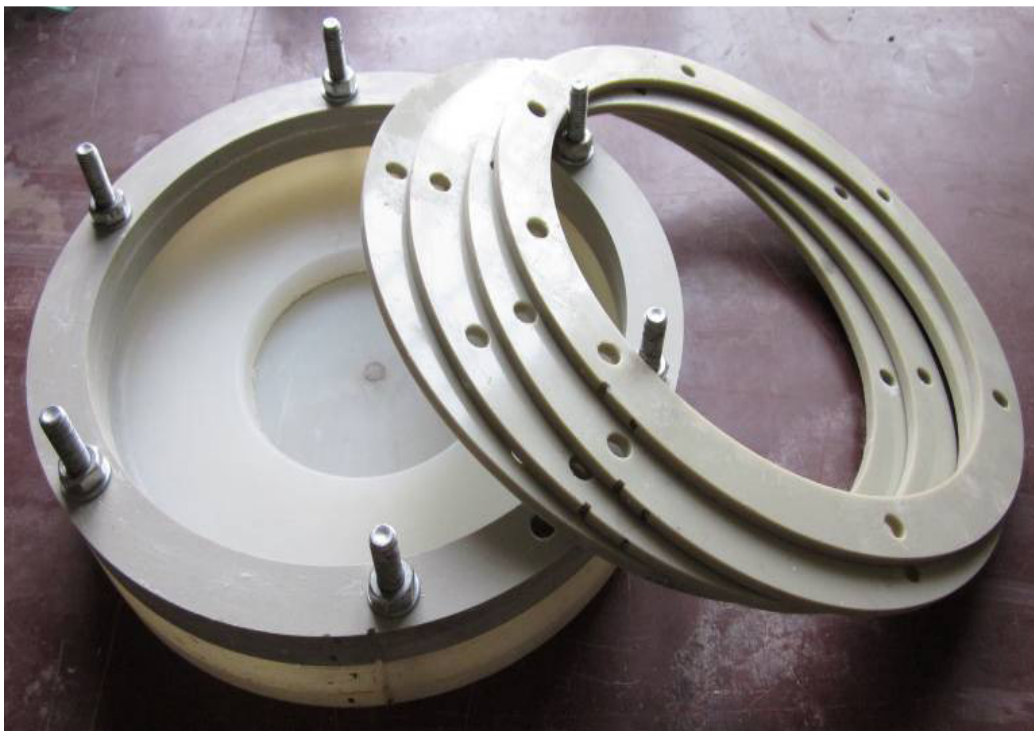
Obrázek 2: Forma na zkušební tělesa pro zkoušku požární odolnosti
