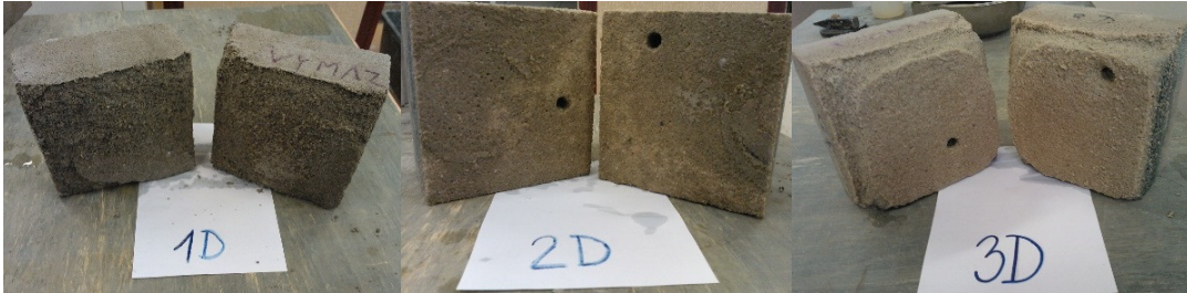
Obrázek 6.: Zkušební tělesa po provedení zkoušky CHRL (zleva 1D, 2D, 3D)
