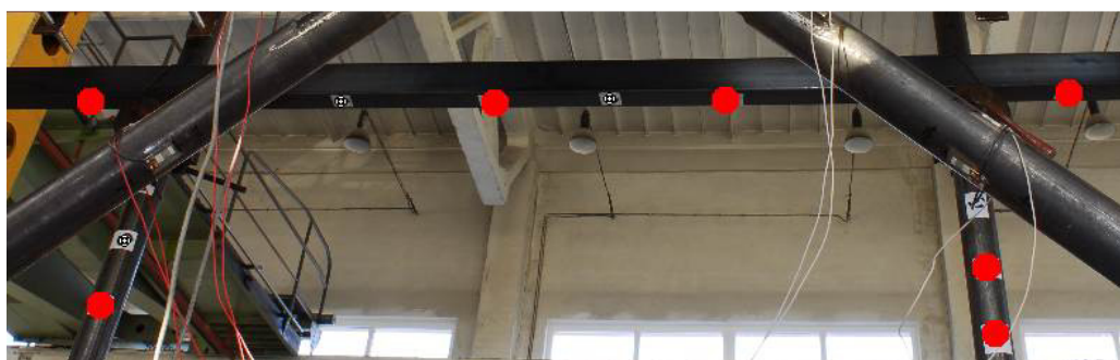
Obrázok 4.: Vzťažné pevné body mimo pozorovaného objektu.
