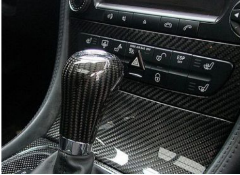
Obrázek 2.: Interiér automobilu - palubní deska a řadicí páka vyrobené z čedičových vláken (zdroj foto www.basfiber.com )
