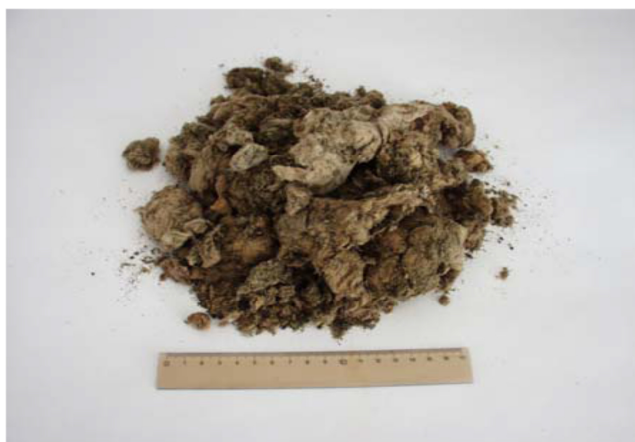
Obrázek 1.: Znečištěné chomáče odpadní minerální vlny s granáliemi
