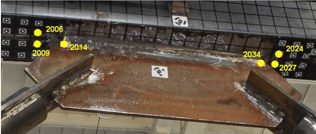
Obrázok 8.: Body s najvyššou mierou deformácie v oblasti styčnického plechu.
