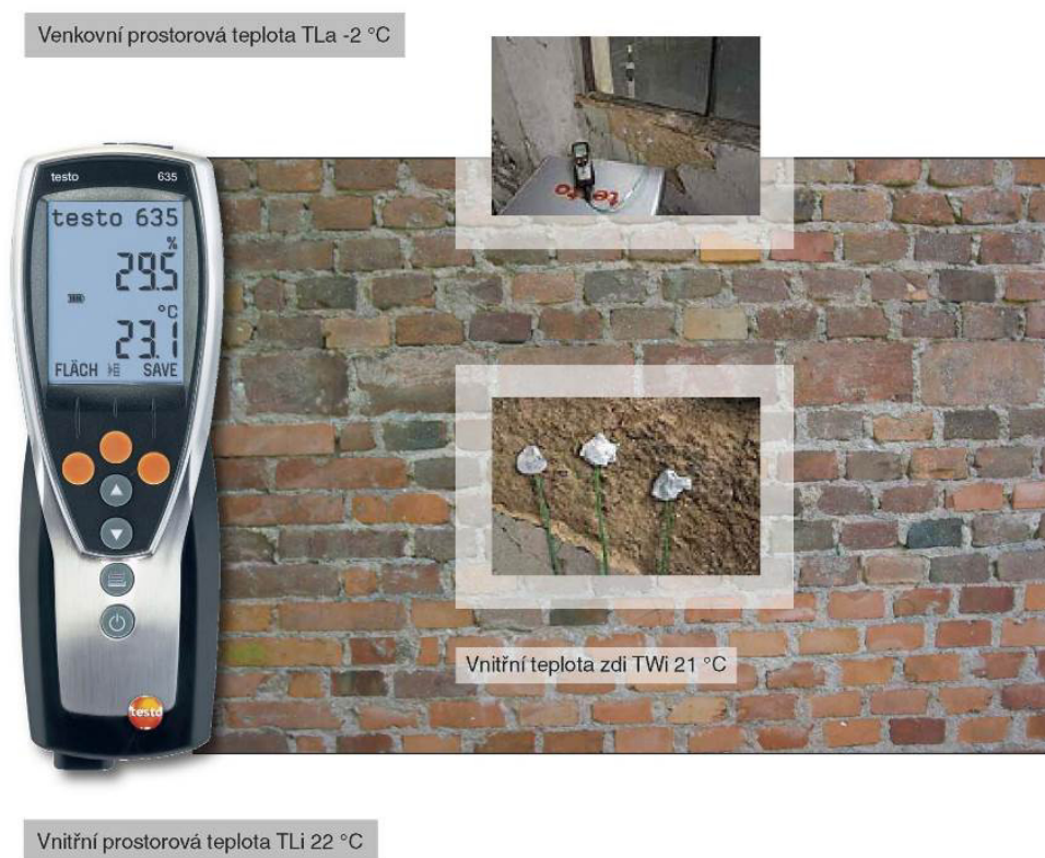
Obrázek 5.: Měření prostupu tepla pomocí měření tří teplot
