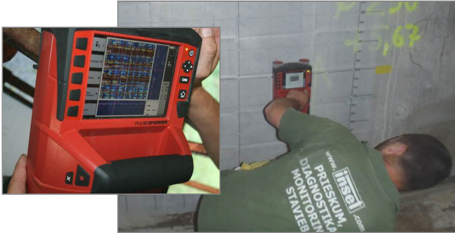
Obrázok 2.: Vyhľadávanie výstuže radarom PS 1000 X-scan
