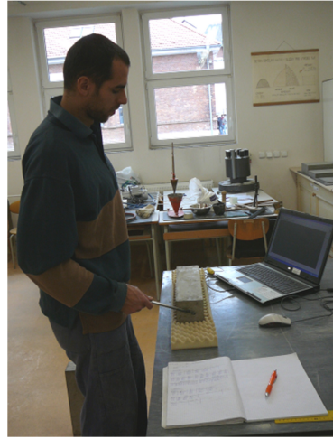
Obrázek 4.: Stanovení dynamického modulu pružnosti pomocí rezonanční metody.
