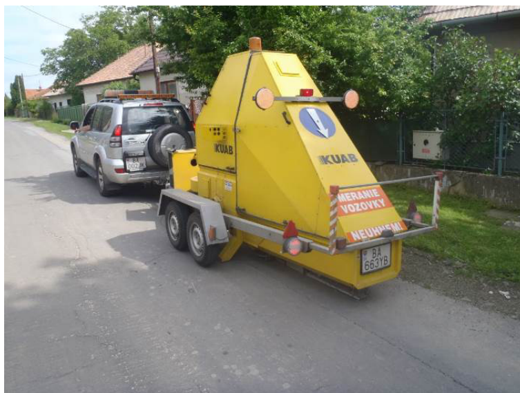
Obrázok 4. Príklad merania – Kuab FWD
