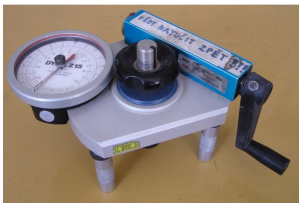
Obrázek 1.: Přístroj DYNA pro měření odporu proti vytrhnutí
