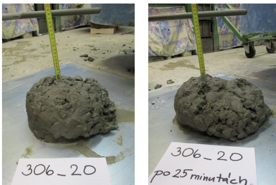
Obrázek 3.: Vzhled popílkového betonu v čase, receptura 306-20, vlevo sednutí 180 mm 5 minut po přidání vody, vpravo sednutí 170 mm 25 minut po přidání vody
