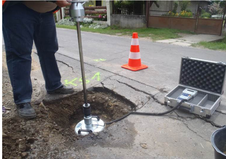
Obrázok 8 .Príklad realizácie skúšky ľahkou dynamickou doskou v kopanej sonde
