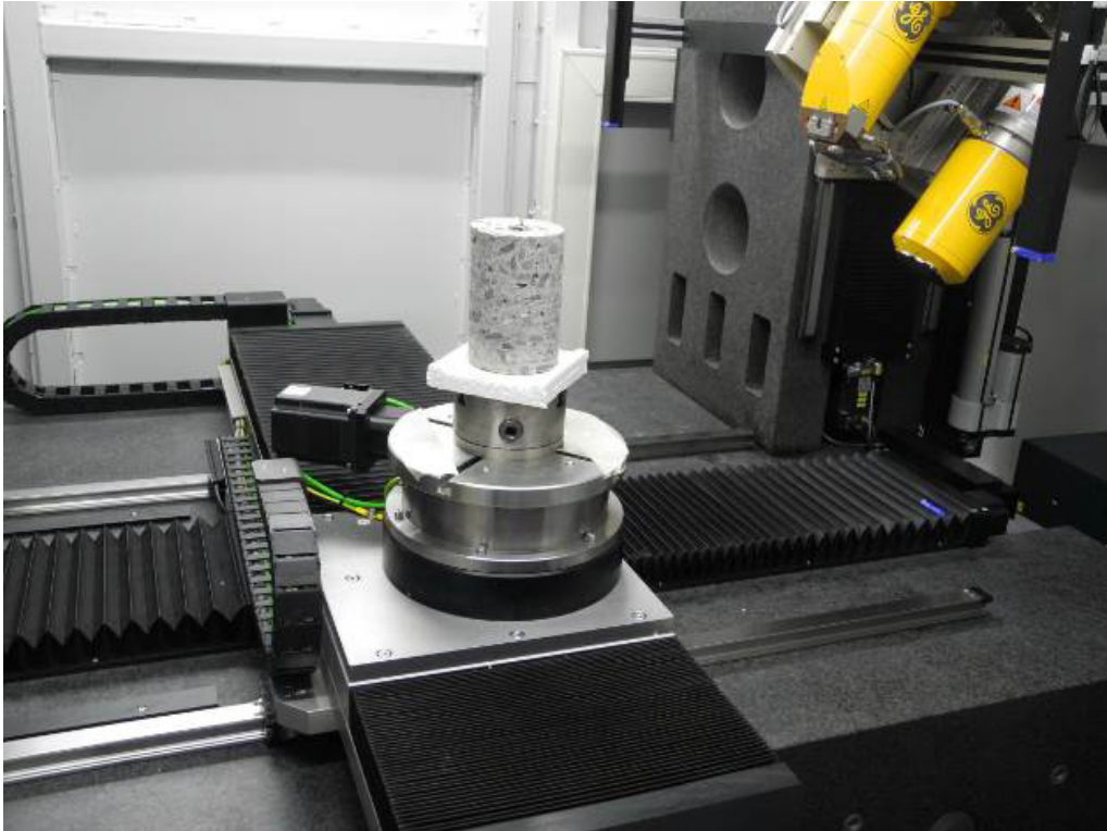
Obr. 6: Válcový vzorek upevněný v manipulátoru
