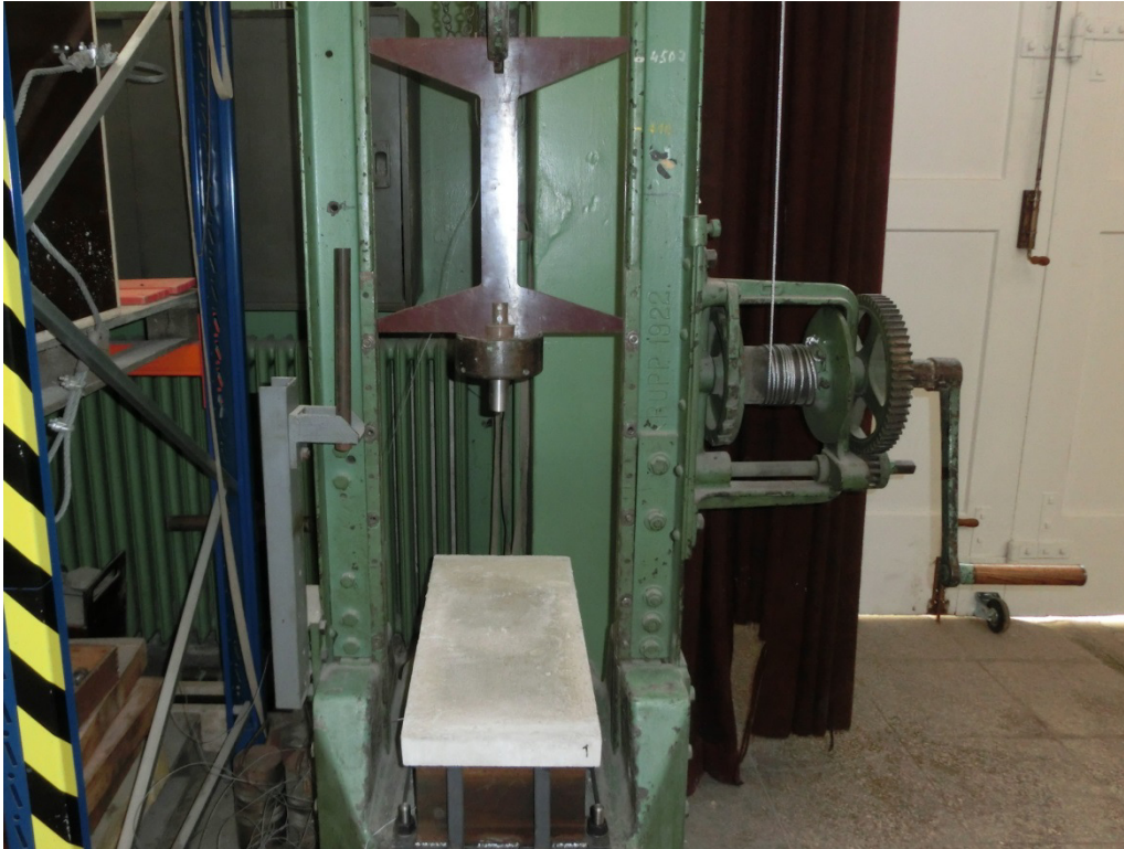
Obrázek 2.: Pohled na uspořádání zkoušky v padostroji.
