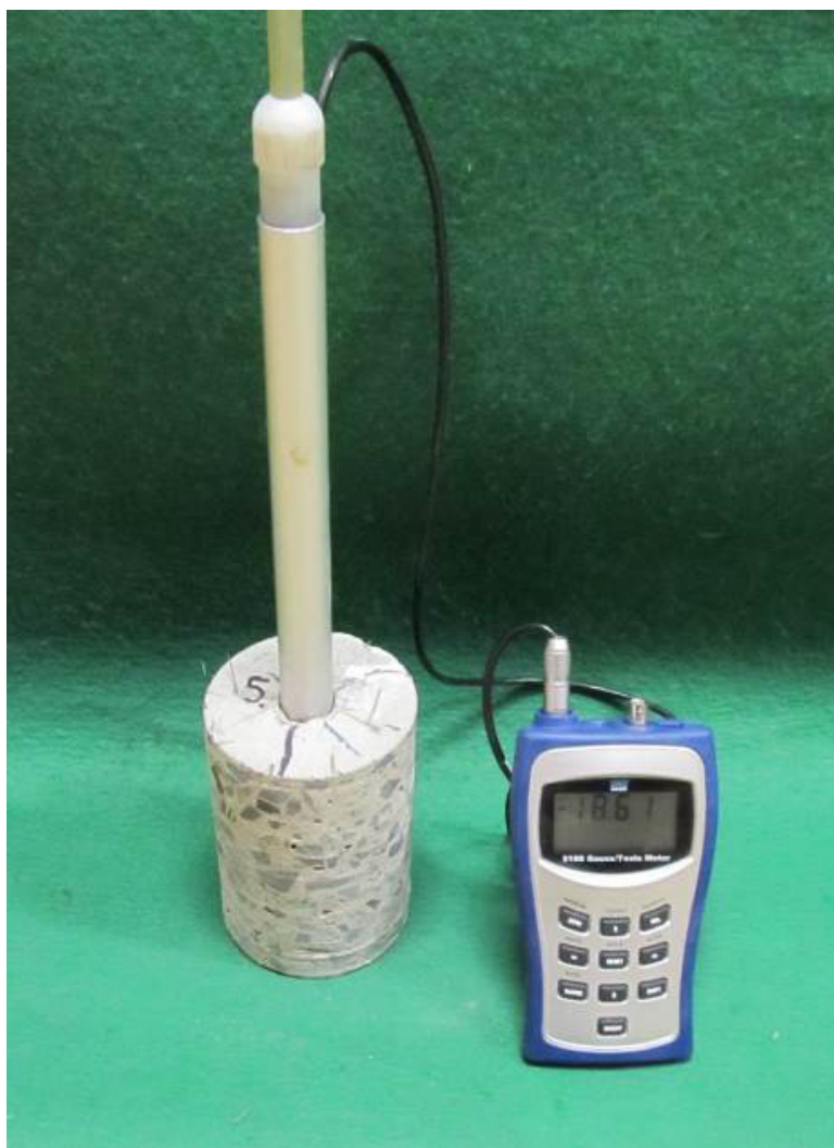
Obr. 5: Válcový vzorek průměru 10 cm se sondou
