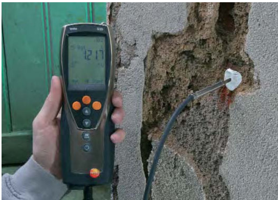
Obrázek 4.: Měření vlhkosti zdiva pomocí metody rovnovážné vlhkosti.
