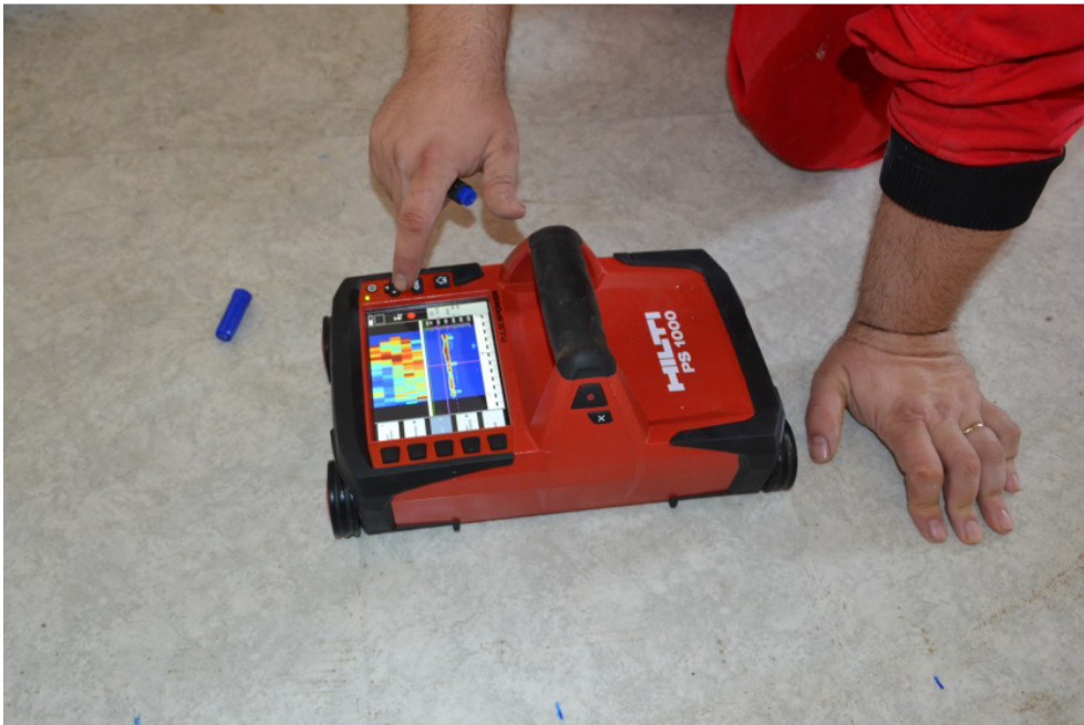
Obrázek 2.: Sonda přístroje Hilti PS 1000 při liniovém skenování stropní konstrukce
