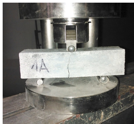
Obrázek 2.: Zkouška pevnosti v tlaku (vlevo) a pevnosti v tahu ohybem (vpravo)
