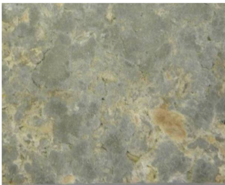
Obrázek 2.: Povrch laboratorně vyrobené desky se 100 % náhradou kamenné vlny
