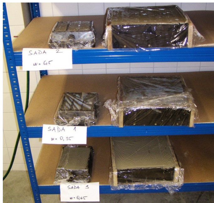
Obrázek 3.: Sady zkušebních těles po vybetonování
