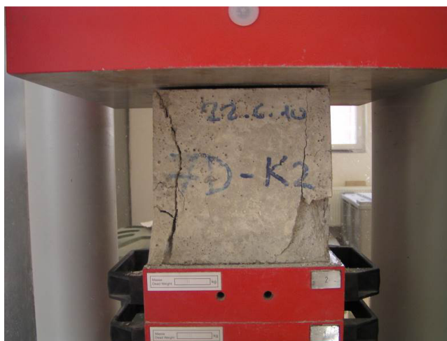
Obrázek 2.: Krychle 7D-K2 po zkoušce pevnosti v tlaku betonu.
