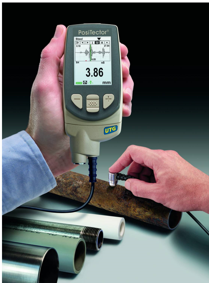
Obr. 6: PosiTector® UTG měří tloušťku základního materiálu
