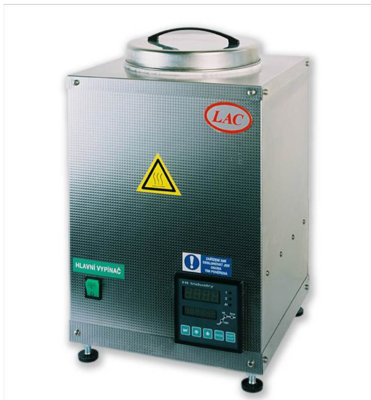
Obrázek 1.: Laboratorní muflová pec pro zkoušku požární odolnosti
