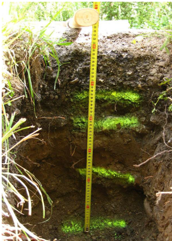
Obrázok 5 .Príklad zistených vrstiev vozovky v kopanej sonde z boku vozovky (v krajnici)
