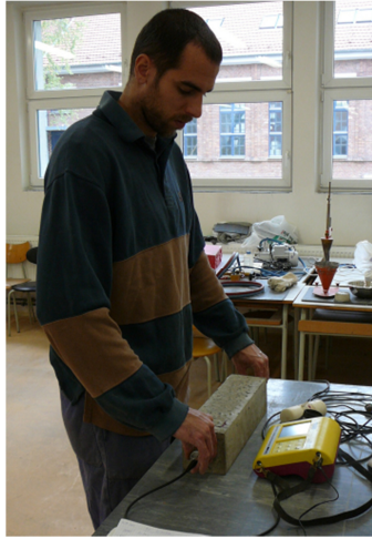
Obrázek 3.: Stanovení dynamického modulu pružnosti pomocí UZ přístroje TICO.
