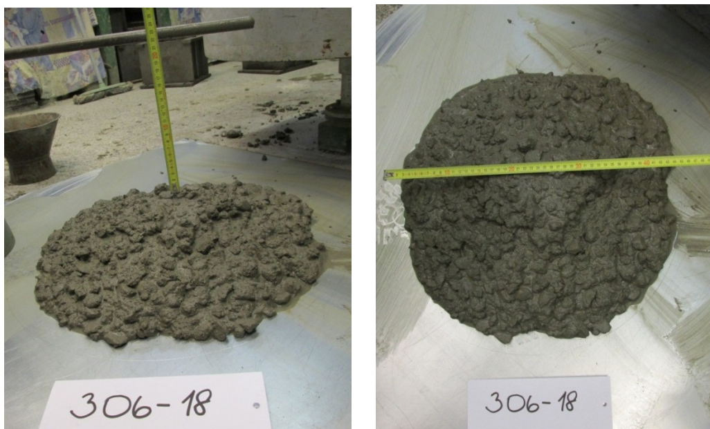
Obrázek 1.: Vzhled popílkového betonu v čase 5 minut po přidání vody, receptura 306-18, vlevo sednutí 230 mm, vpravo rozlité 450/480
