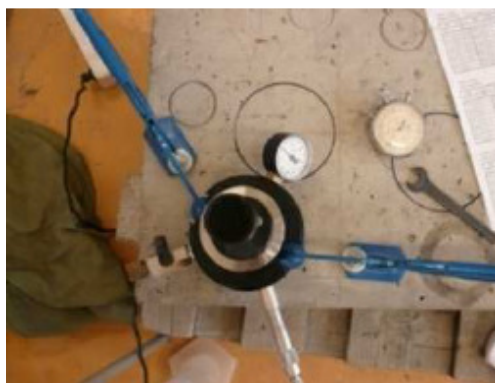
Obrázek 2.: Měřicí zařízení, metoda GWT [4]
